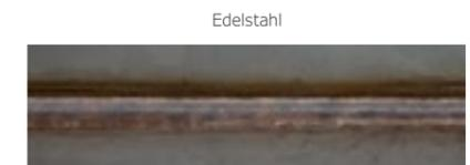
**Die smarte Lösung von Lorch:** Der MicorMIG Pulse-Lichtbogen bringt weniger Energie ins Werkstück ein und vermeidet so unnötige Anlauffarben. Zeitaufwändige und kostenintensive Nacharbeit, beispielsweise für das Entfernen der Anlauffarben, werden mit dem MicorMIG Pulse-Lichtbogen reduziert. Und das Ganze bei sauberer Wurzel-erfassung.
