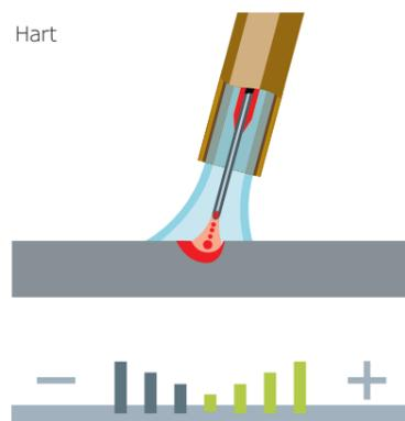
Die Dynamikregelung ermöglicht einen breiteren oder schmaleren Lichtbogen – wie es dem Schweißer beliebt.
