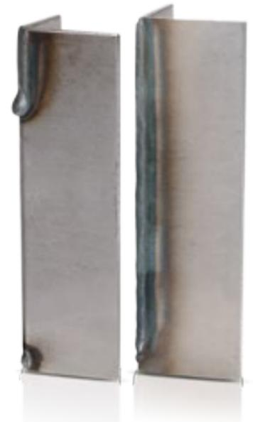
Eine geschweißte Ecknaht im Vergleich. Standard-Lichtbogen (links): Sehr schnell vorlaufendes Schmelzbad, kurz vor dem Herunterfallen. SpeedCold (rechts): Komplet, sicher und schnell geschweißt (35 cm/min).
