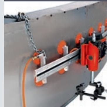
Mit der Lorch Vakuum-Fixierung kann das Schweißen von Werkstücken aus Aluminium und Edelstahl, trotz schwacher ferromagnetischer Eigenschaft des Werkstücks, problemlos gewährleistet werden.
