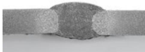
Optimales, leicht überwölbtes Nahtbild ohne Bindefehler – für ein Höchstmaß an Spalttoleranz und Spaltüberbrückung.
