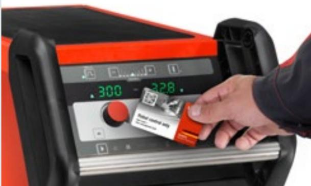
Durch die NFC-Technologie mit kontaktlosem Datentransfer ist eine Benutzeridentifikation und -authorisierung jederzeit möglich. Serienmäßig wird die Anlage mit zwei Berechtigungskarten ausgeliefert: „Administrator“ und „Robot control only“.
